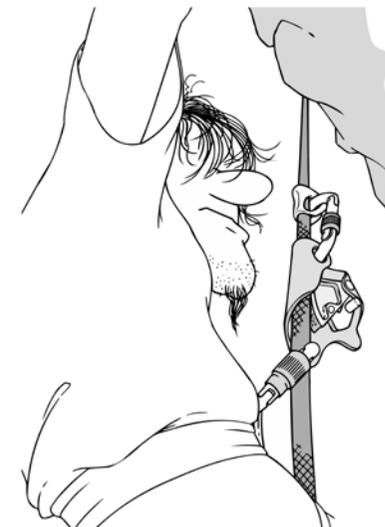
► Wichtig ist die Verwendung eines entsprechenden Seildurchmessers, um die optimale Funktion der Klemme zu gewährleisten.
